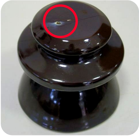
«Пробой» изолятора ШФ
