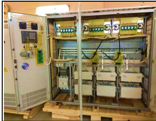
Трехфазный индуктивный (а) и конденсаторный (б) КРМ 0,4 кВ мощностью 200 кВАр
