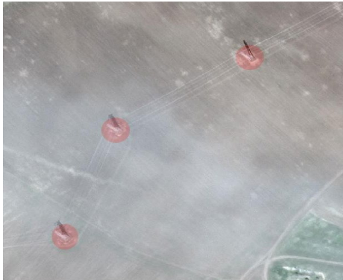
Детекция опор ВЛ
