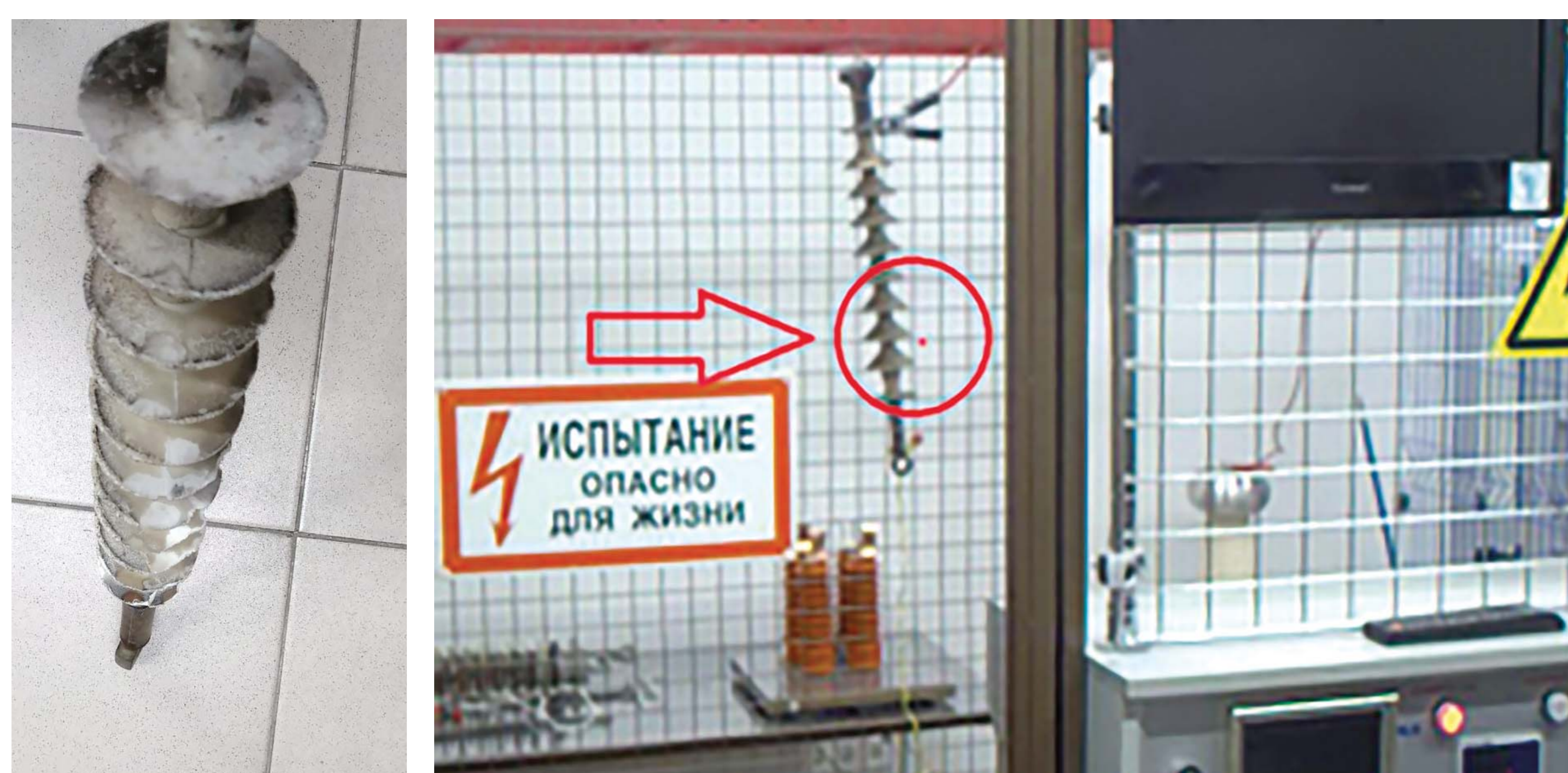
Дефект полимерного изолятора
